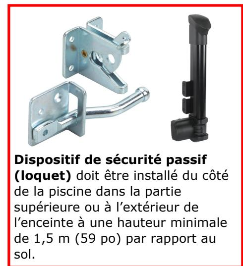
**Dispositif de sécurité passif (loquet)** doit être installé du côté de la piscine dans la partie supérieure ou à l'extérieur de l'enceinte à une hauteur minimale de 1,5 m (59 po) par rapport au sol.
