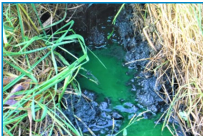
Fuite d'un système septique détectée à l'aide d'un test de colorant
